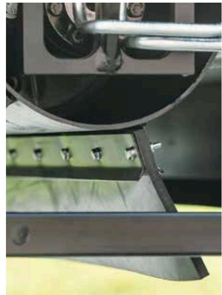
Die Sammelwalze mit ihren 6 Sammellippen aus gewebeverstärktem Hochleistungskautschuk wird hydraulisch angetrieben.
